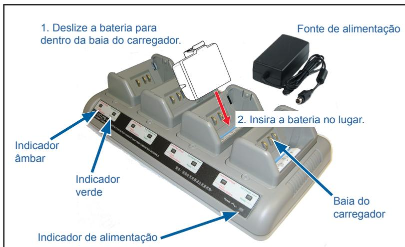
Os pacotes de baterias que estão apenas parcialmente descarregados levarão menos tempo para atingir seu estado carregado. As baterias que atingiram 80% de sua capacidade de carga podem ser usadas; entretanto, é recomendável que se deixe as baterias atingirem sua carga completa, para manter a máxima vida útil da bateria.
