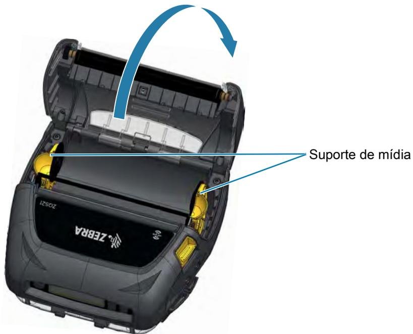
3. Puxe os suportes de mídia para separá-los, conforme mostrado na [Figura 19](#). Ao mover um suporte, os dois suportes se moverão.
