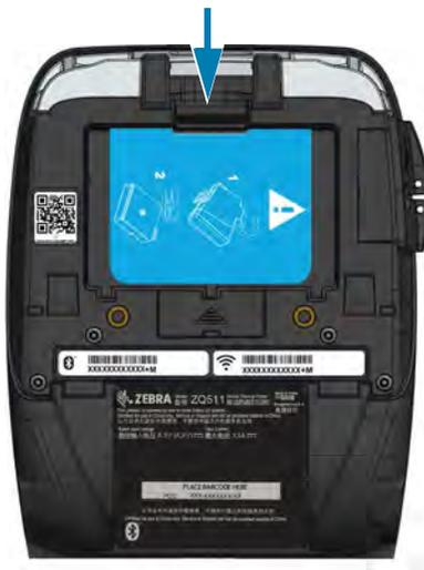
3. Gire o pacote de bateria para a frente e levante-o para fora do compartimento da bateria (Figura 6).
