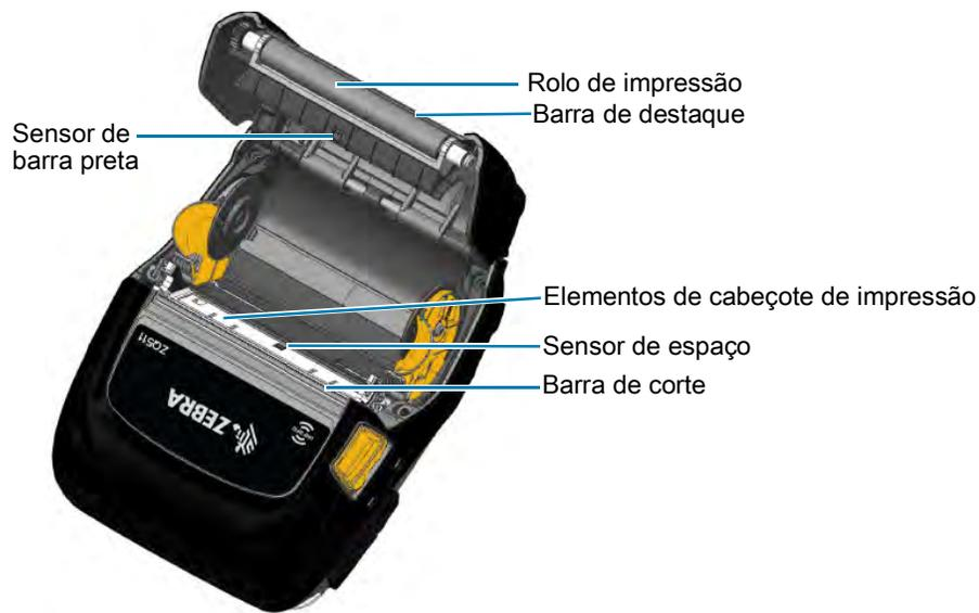
**Figura 40** Locais de limpeza (impressora sem revestimento)
