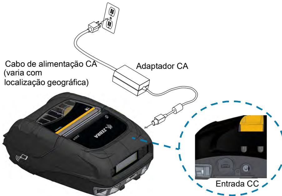
1. Abra a tampa de proteção na impressora para expor o conector do carregador de entrada CC.
