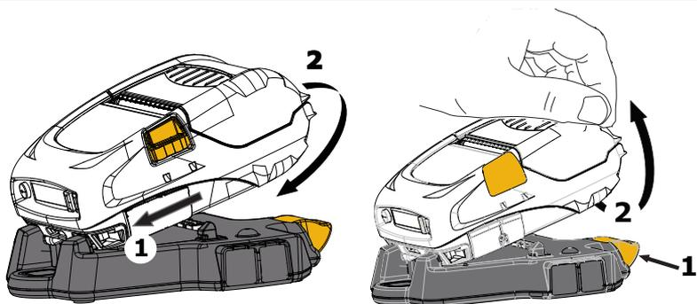
**Figura 6: Como acoplar e desacoplar da estação elétrica de 4 baias**
