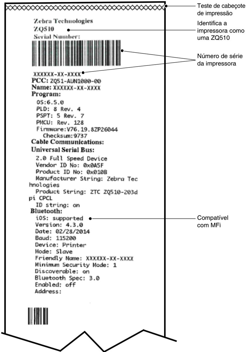
**Figura 21b: Etiqueta de configuração da série ZQ500 (cont.)**
