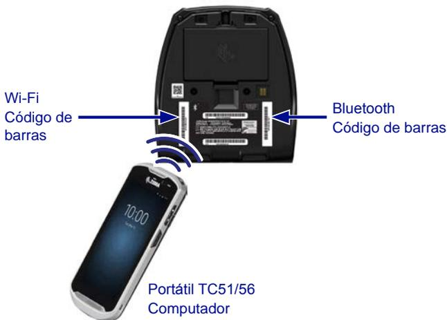
Para obter o endereço Bluetooth ou o endereço da LAN sem fio, use um computador portátil para digitalizar o código de barras do Bluetooth ou da WLAN, na parte inferior da impressora, conforme mostrado na Figura 23.
