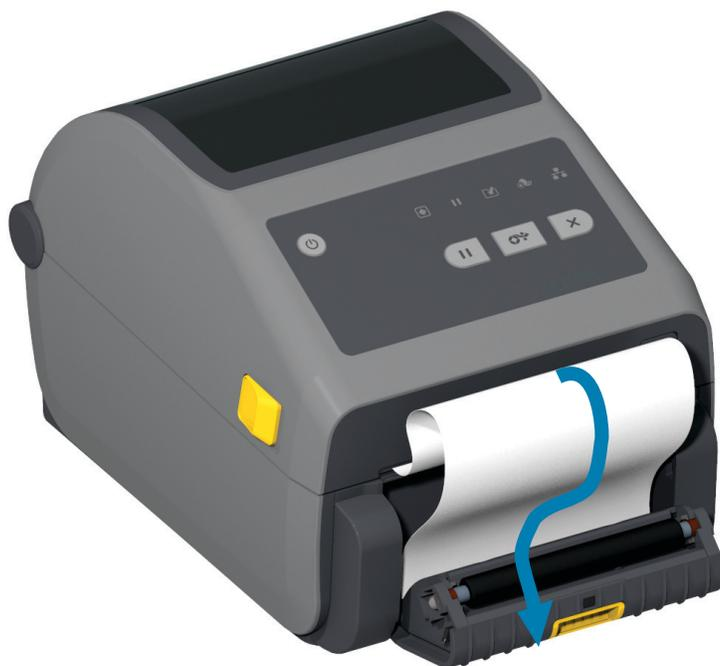
4. Feche a porta do distribuidor enquanto puxa firmemente a extremidade do revestimento da etiqueta.
