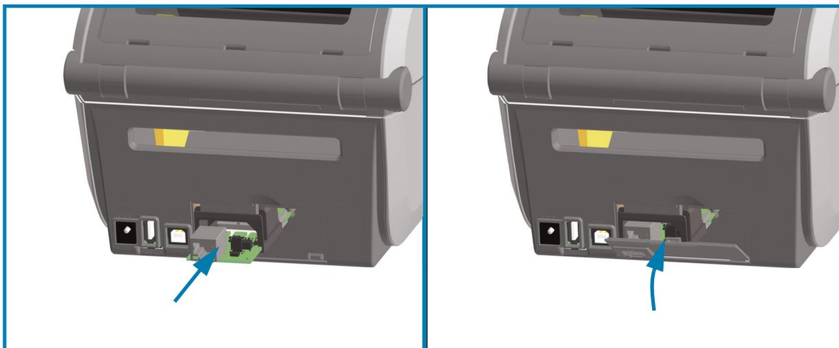
1. Com o conector de alimentação CC e a porta de acesso do módulo removida, deslize o módulo de Ethernet para dentro da impressora.
