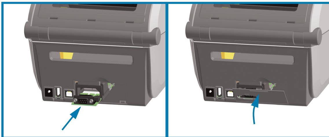
1. Com o conector de alimentação CC e a porta de acesso do módulo removida, deslize o módulo da porta serial para dentro da impressora.
