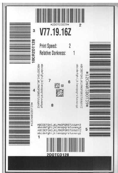
4. Consulte a [Figura 2](#) e a [Tabela 1](#). Inspeção as etiquetas de teste e determine qual tem a melhor qualidade de impressão para a aplicação. Caso tenha um verificador de código de barras, utilize-o para medir as barras/espacos e calcular o contraste da impressão. Se não tiver, utilize seus olhos ou o scanner do sistema para escolher a configuração de tonalidade de escuro ideal com base nas etiquetas impressas neste autoteste.
