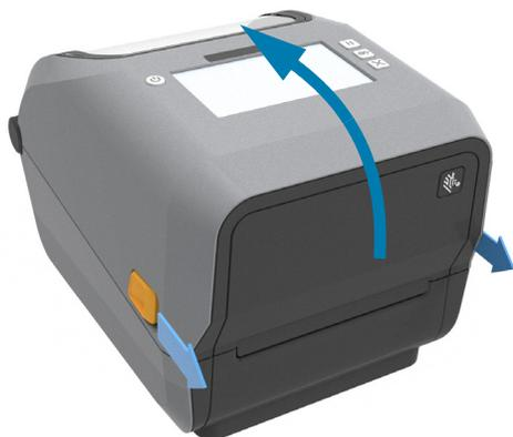
2. Abra os suportes do rolo de mídia. Oriente o rolo de mídia de modo que a superfície de impressão fique voltada para cima ao passar por cima do rolo (acionamento) de impressão. Puxe e abra as guias de mídia com suas mãos e coloque o rolo de mídia nos suportes de rolo e solte as guias. Verifique se o rolo gira livremente. O rolo não deve se apoiar na base do compartimento de mídia.
