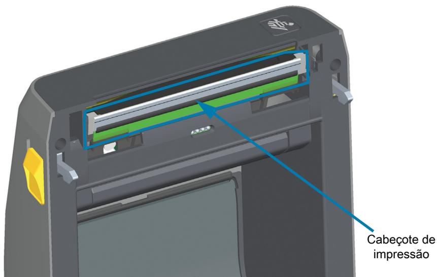
2. Empurre a trava de liberação do cabeçote de impressão para longe do cabeçote de impressão. O lado direito do cabeçote de impressão se solta.
