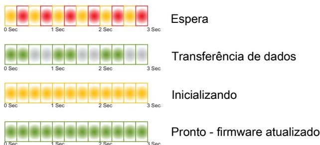
O Indicador de STATUS alterna entre Âmbar e Vermelho. Se soltar o botão AVANÇAR aqui, a impressora começa a aguardar os dados para iniciar o download (do arquivo do firmware da impressora).
