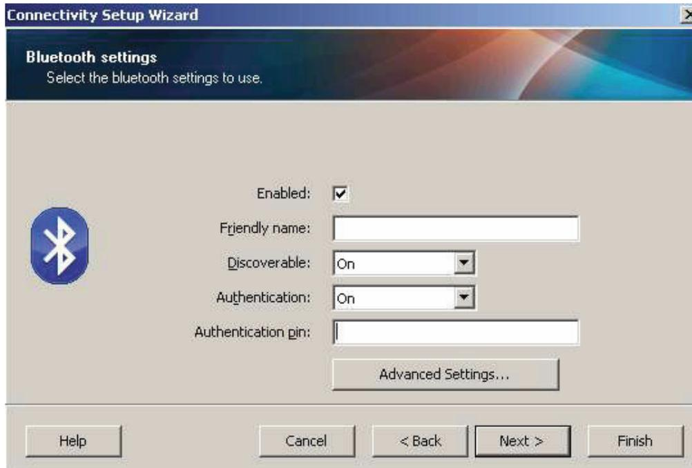
10. Se o dispositivo central usar BT v2.1 ou mais recente, esta configuração não tem efeito. BT v2.1 e mais recente usa o Pareamento Simples Seguro (SSP) que não requer o uso de um PIN.
