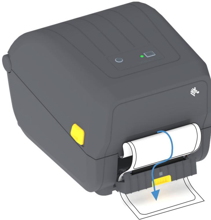
4. Feche a porta do distribuidor enquanto puxa firmemente a extremidade do revestimento da etiqueta.
