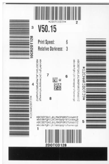
4. Consulte a [Figura 26](#) e a [Tabela 18](#). Inspecione as etiquetas de teste e determine qual tem a melhor qualidade de impressão para a aplicação. Caso tenha um verificador de código de barras, utilize-o para medir as barras/espacos e calcular o contraste da impressão. Se não tiver, utilize os seus olhos ou o scanner do sistema para escolher a configuração de tonalidade de escuro ideal com base nas etiquetas impressas neste autoteste.
