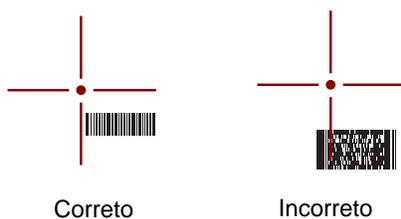
**Figura 3-5** Padrão de mira do captador de imagens: código de barras não centralizado
