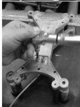
Prenda o suporte à base com os quatro parafusos e fixe o transformador com os dois parafusos por cima do suporte.
