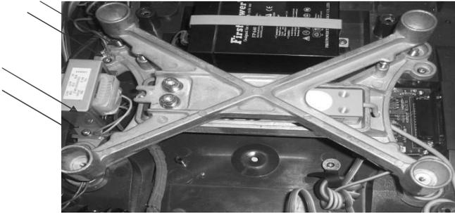
Remova os cabos da célula de carga que são fixados na placa de displays frontal.
