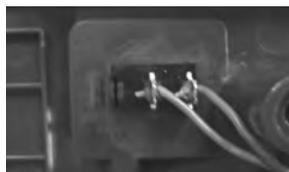
Para remover a chave basta remover os fios e pressionar suas laterais forçando o conector para baixo. Para montá-lo execute o processo inverso lembrando-se de colocar a capa plástica protetora.
