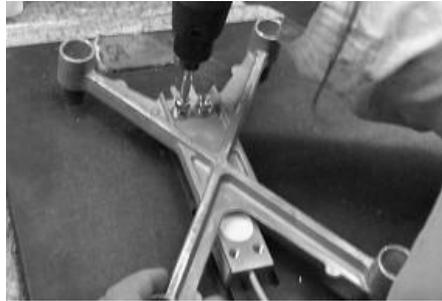
Vire a célula de carga, encaixe o suporte e parafuse com uma chave allen de acordo com as figuras. A arruela lisa deve ficar em contato com o suporte e a arruela de pressão deve ficar em contato com a cabeça do parafuso.
