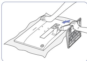
Introduza a parte superior da base no orifício de ligação, na direcção ilustrada na figura.
