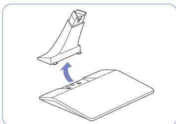
Retire o conector da base puxando-o na direcção da seta, conforme ilustrado na figura.
