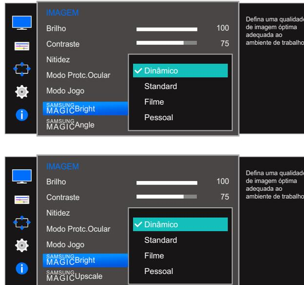
Se a entrada externa estiver ligada através de HDMI, e o **Modo PC/AV** estiver definido para **AV**, a opção **SAMSUNG MAGICBright** tem quatro definições de imagem automáticas (**Dinâmico**, **Standard**, **Filme** e **Pessoal**) que são predefinidas na fábrica. Pode activar **Dinâmico**, **Standard**, **Filme** ou **Pessoal**. Pode seleccionar **Pessoal** para voltar a chamar automaticamente as definições de imagem personalizadas.
