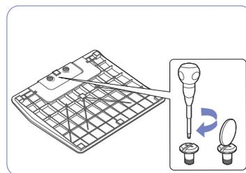
Rode o parafuso de ligação existente na parte inferior da base até este ficar totalmente fixo.
