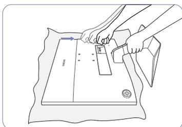
Segurando a haste da base com uma mão, bata com a outra mão fechada na parte superior da base na direcção da seta, para soltar a parte inferior da base.
