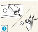
Se colocar o transformador de corrente CA/CC com a entrada do cabo virada para cima, água ou outras substâncias estranhas podem entrar no transformador e provocar uma avaria no mesmo.
