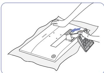
Empurre a base montada para a parte principal do corpo, na direcção da seta, conforme ilustrado na figura.
