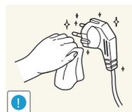
Limpe o pó à volta dos pinos da ficha ou da tomada eléctrica com um pano seco.
