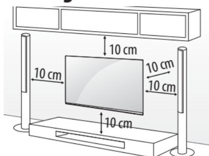
Instale o Suporte em uma parede sólida perpendicular ao piso. Ao instalar em outros materiais ou posição, poderão ocorrer acidentes ou danos. Evite prejuízos desnecessários, falando com seu revendedor e contratando somente pessoal qualificado para efetuar a instalação do aparelho na parede.
