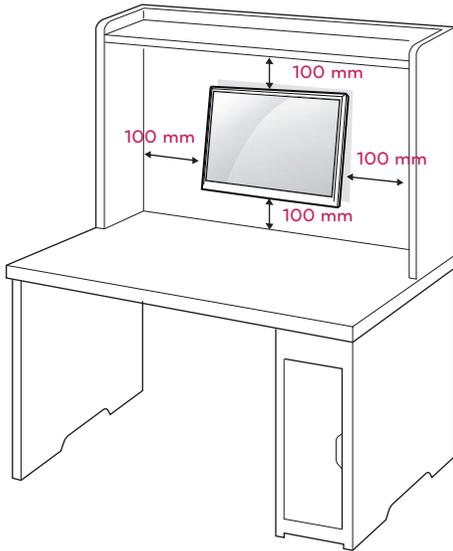
Se você pretende montar o monitor na parede, fixe o suporte de montagem (peça opcional) à parte traseira do monitor.
