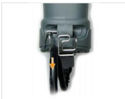
Passo 2. Desengate a parte esquerda do clipe do orifício e o vire no sentido horário. Enquanto estiver virando o clipe, empurre o clipe por entre o orifício para removê-lo.
