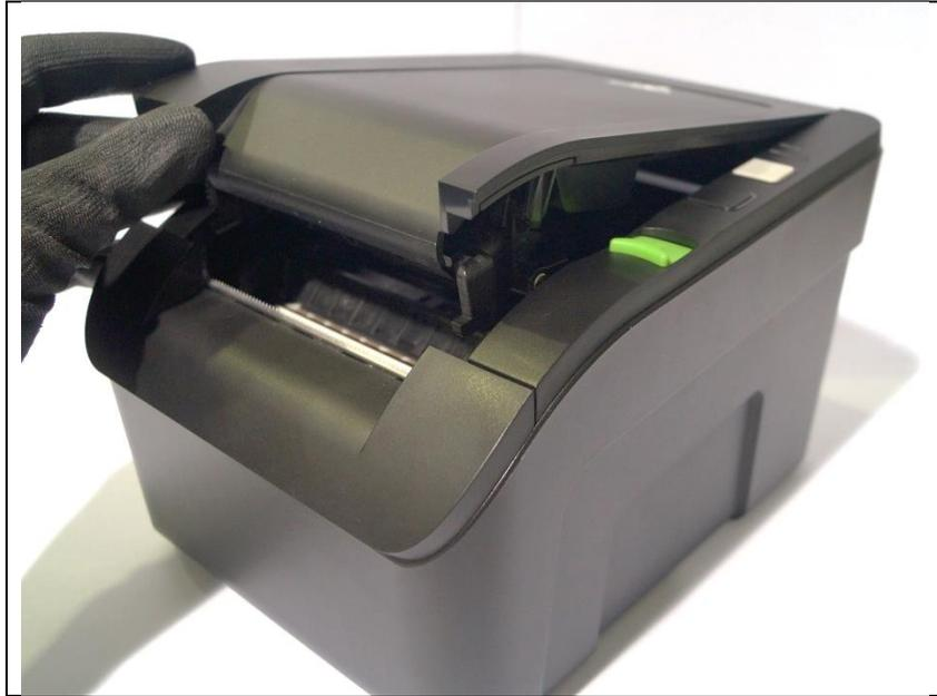
(2) No interior da impressora, com um instrumento ou ferramenta pontiaguda, movimente o sensor para cima ou para baixo, conforme a indicação das setas, alterando a posição do sensor. Faça esse ajuste com cuidado para não danificar o sensor ou seu suporte.
