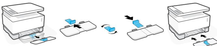
1. Incline a bandeja de entrada levemente para cima e retire-a da impressora.
