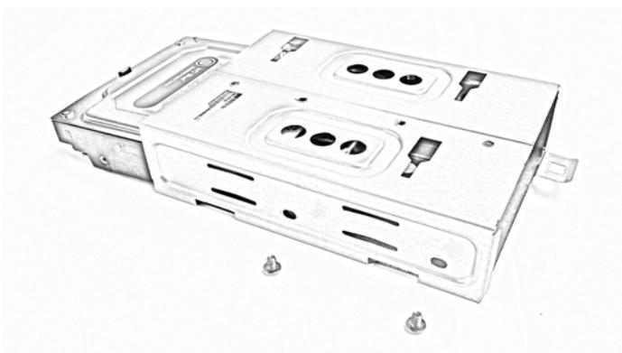
Guarde os parafusos para usar na nova unidade de disco rígido.
