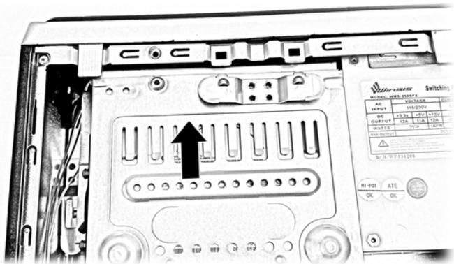
10. Aperte o parafuso para prender o compartimento da unidade de disco óptico no chassi.
