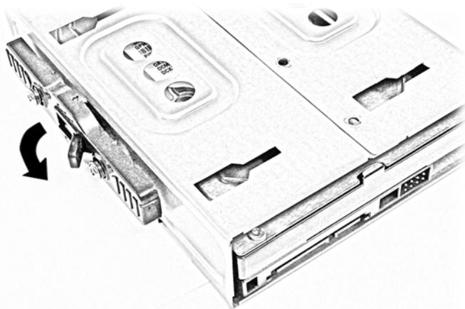
11. Remova os dois parafusos na lateral do compartimento da unidade de disco rígido e depois deslize a unidade para fora do compartimento.
