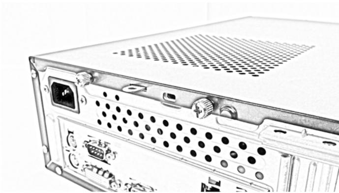
6. Deslize o painel para trás (1) e levante-o para fora do computador (2).
