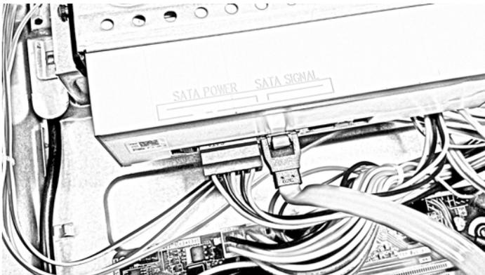
12. Conecte a extremidade oposta do cabo de dados ao conector SATA2 na placa do sistema.
