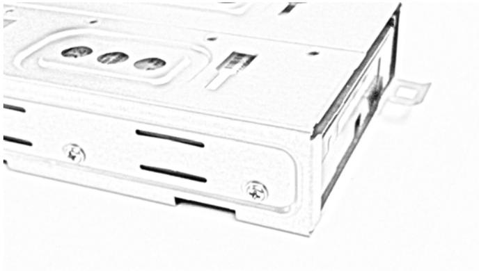
15. Segure o compartimento da unidade de disco rígido com os conectores ao lado da fonte de alimentação e alinhe as aberturas na parte inferior do compartimento com os cliques salientes na parte inferior do chassi.
