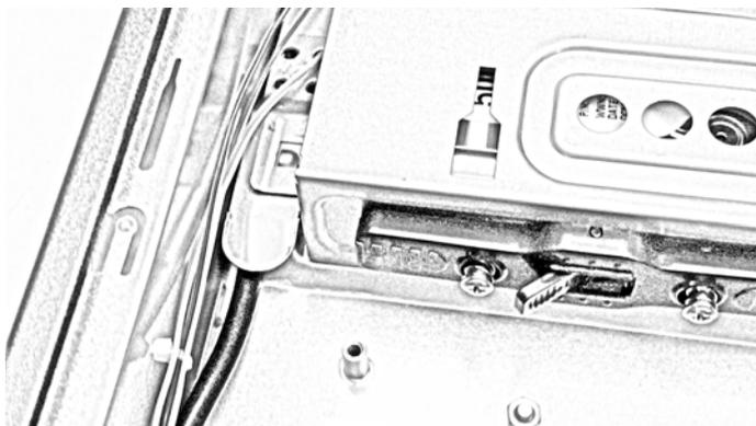
9. Deslize a unidade de disco rígido para longe da extremidade do chassi para soltar o compartimento da unidade de disco rígido e, em seguida, levante-a para fora do chassi.
