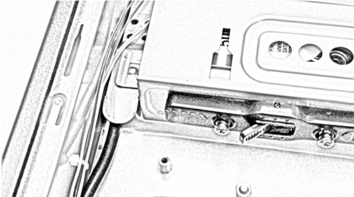
17. Conecte os cabos de alimentação e de dados na parte traseira da unidade de disco rígido.
