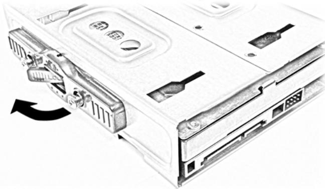
14. Aperte os dois parafusos no outro lado do compartimento da unidade de disco rígido para prender a unidade ao compartimento.
