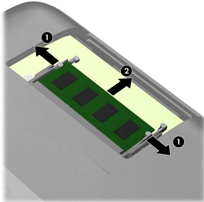
9. Deslize a nova SODIMM no soquete em um ângulo de aproximadamente 30° (1), em seguida pressione a SODIMM (2) para que a trava seja bloqueada em seu lugar.
