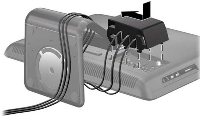
7. Reinstale o painel de acesso central (consulte [Reinstalação do Painel de Acesso Central na página 14](#)) e conecte o cabo de alimentação em uma tomada elétrica.
