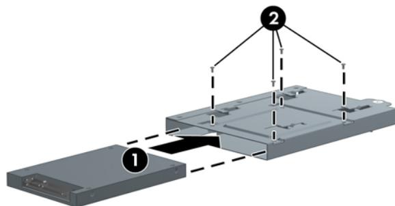
12. Coloque o compartimento para unidades de disco rígido no compartimento e deslize-o para a parte central do computador até que pare.
