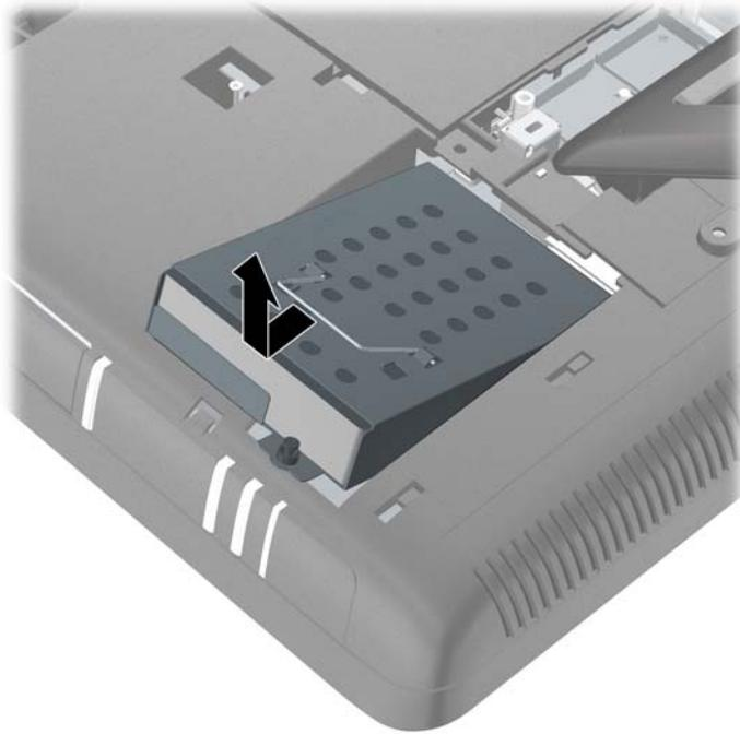
10. Para remover a unidade de disco rígido de seu compartimento, remova os quatro parafusos que prendem a unidade no compartimento (1), em seguida deslize a unidade para fora do compartimento (2).
