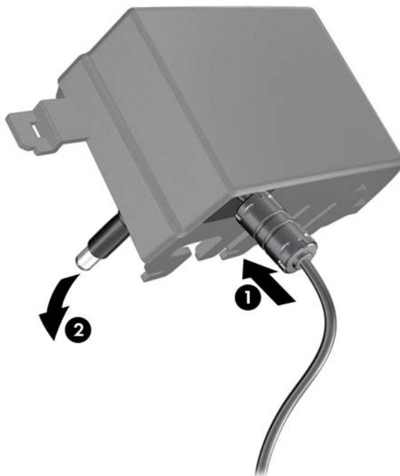
4. Conecte o cabo da fonte de alimentação no conector de alimentação na parte traseira do computador (1), conecte o segundo cabo de alimentação na fonte de alimentação (2).
