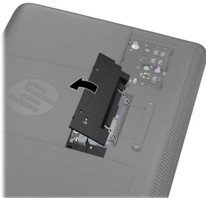
13. Para prender o computador em um braço articulado para monitor, insira os quatro parafusos de 10 mm nos orifícios da placa do braço articulado para monitor e nos orifícios de montagem VESA do computador.
