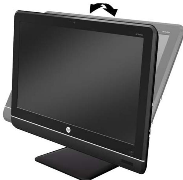
O computador possui uma roda de giro na parte inferior da base que lhe permite girar o computador para a esquerda ou para a direita para obter o melhor ângulo de visualização.
