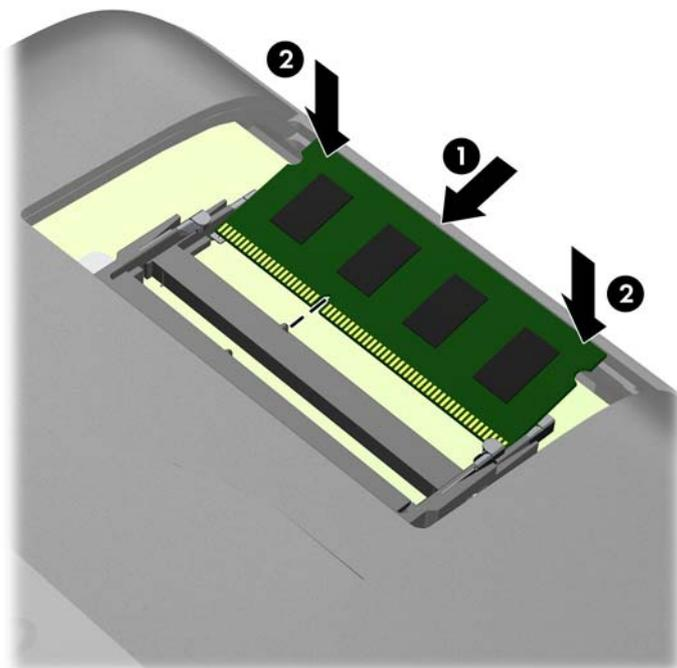
**NOTA:** O módulo de memória só pode ser instalado de uma maneira. Alinhe a ranhura existente no módulo com a guia no soquete de memória.
