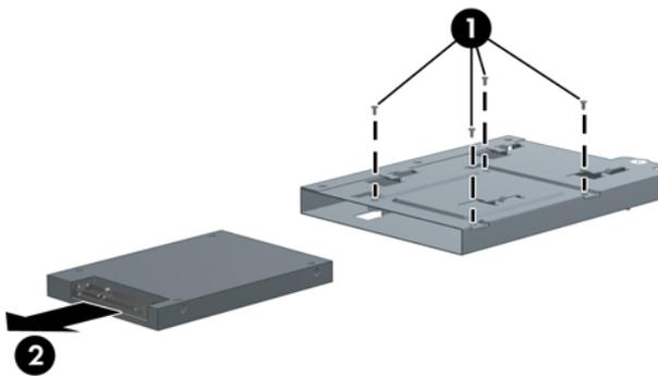
11. Deslize a nova unidade no compartimento para unidade de disco rígido (1) e assegure-se de que os conectores na unidade de disco rígido estejam alinhados na área com entalhe do compartimento, em seguida instale os quatro parafusos que prendem a unidade no compartimento (2).
