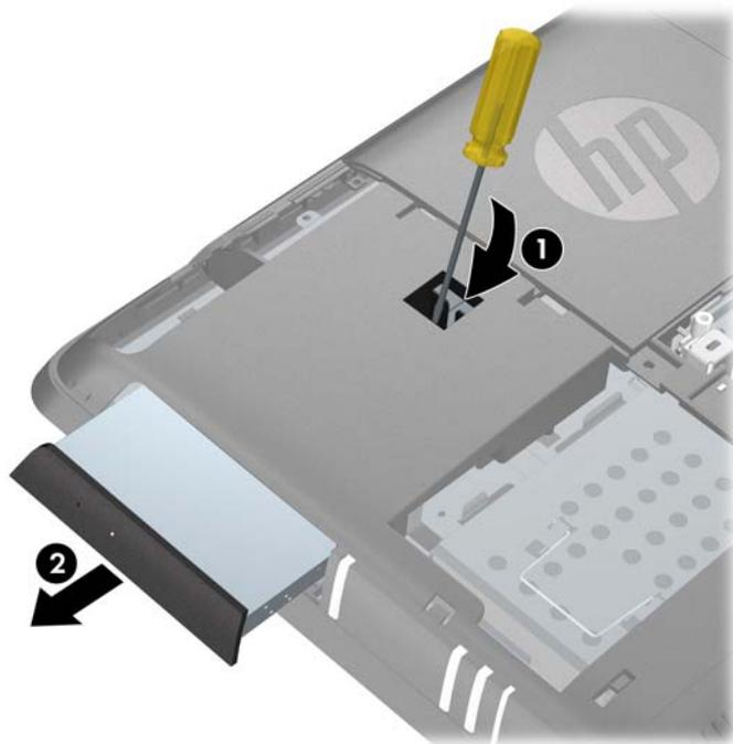
10. Remova o parafuso e o suporte de segurança na parte traseira da unidade. Você precisa instalar o suporte na unidade de substituição.
