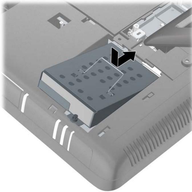
13. Aperte o parafuso de aperte manual para prender o compartimento para unidade de disco rígido em seu lugar.
