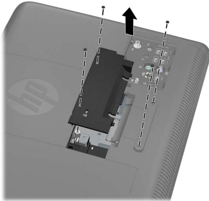
12. Reinstale o painel de acesso central. Insira as guias na parte inferior do painel de acesso nos slots do chassi, em seguida pressione a parte superior do painel para que se encaixe em seu lugar.
