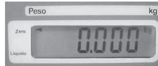
Caso durante a operação, e sem que haja peso sobre o prato, a seta indicativa de Zero se apague, havendo ou não uma indicação de peso diferente de zero, e sem que haja carga sobre o prato, utilize a tecla "Z" para zerar novamente a balança.
