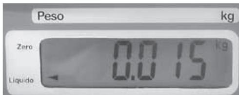
A função de tara é utilizada para descontar o peso de recipientes em geral. Para possibilitar a ativação da função de TARA, a balança precisa estar indicando um valor de peso estável.
