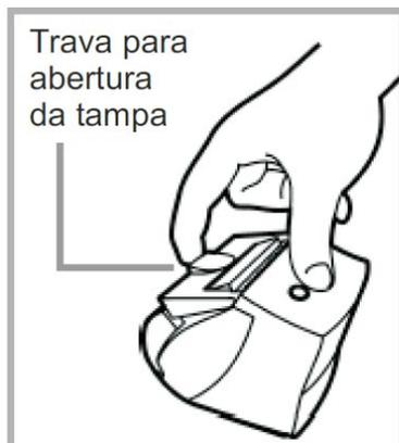
1. Puxe a trava da parte traseira da PR 100 para abrir a tampa da impressora.
