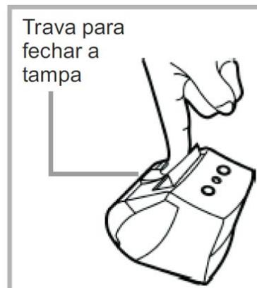
3. Após colocar a bobina de papel, aperte a trava para fechar a tampa da impressora conforme a ilustração acima.
