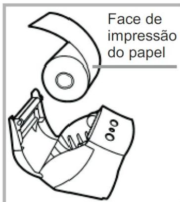
2. Coloque a bobina de papel com a face de impressão voltada para a frente, conforme ilustração acima.
