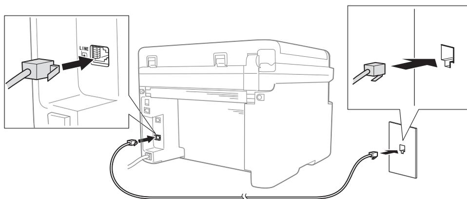
Se você conseguir enviar e receber faxes com a linha telefônica diretamente conectada ao fax, o problema pode não ser do aparelho. Se você tiver problemas de conexão, entre em contato com seu provedor de serviços.
