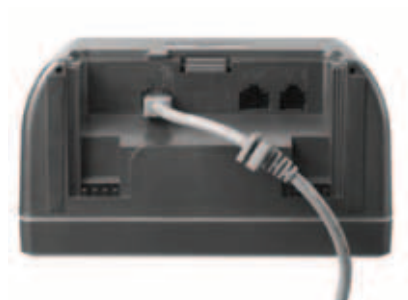
Figura 4: Insira o cabo de comunicação no conector do host
