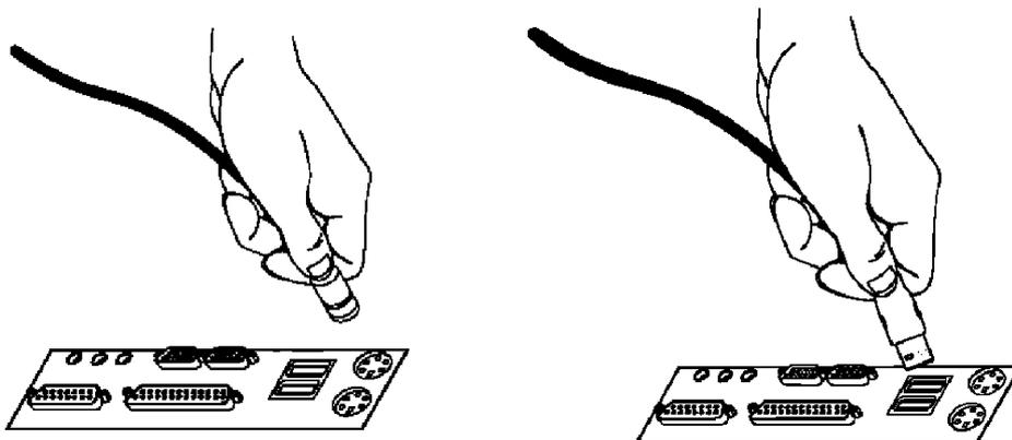
Para ligar o monitor encaixe o conector conforme ilustrado abaixo (cor azul). Para melhor fixação rosquear os parafusos.
