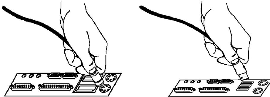
Encaixe o conector do teclado na entrada PS2, ou encaixe o conector do teclado em uma entrada USB qualquer, conforme as ilustrações abaixo:
