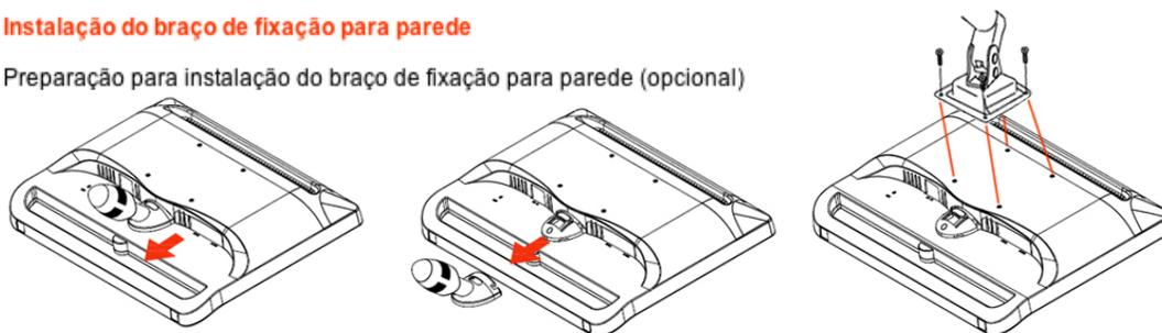
Este monitor pode ser montado num braço de fixação para parede, adquirido separadamente. Desconecte o cabo de alimentação antes deste procedimento. Siga os passos abaixo:
