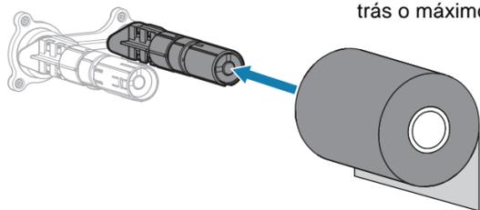
Coloque um núcleo vazio no cilindro de recolhimento da fita, conforme mostrado. Empurre o núcleo para trás o máximo possível.
