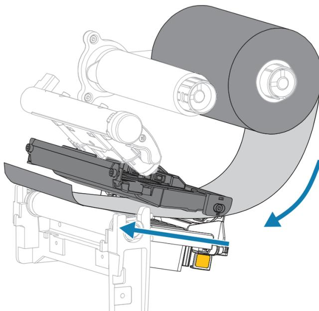
Enrole a fita ao redor do núcleo várias vezes e, em seguida, gire o cilindro para apertar e alinhar a fita.
