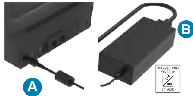
A. Conecte a fonte de alimentação à impressora.
