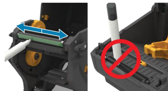
Limpe o cabeçote de impressão com uma caneta de limpeza. Limpe do meio para fora. Não use uma caneta de limpeza no rolo de impressão.
