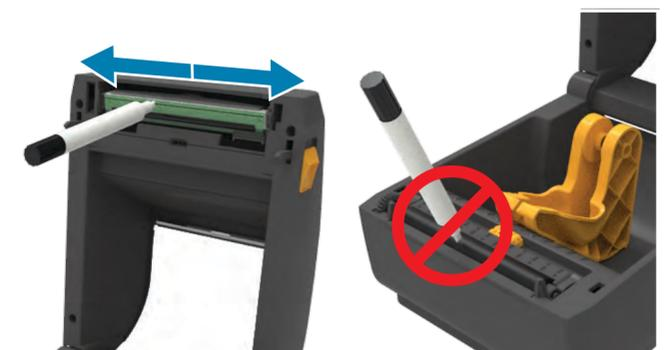
Limpe o cabeçote de impressão com uma caneta de limpeza. Limpe do meio para fora. Não use uma caneta de limpeza no rolo de impressão.
