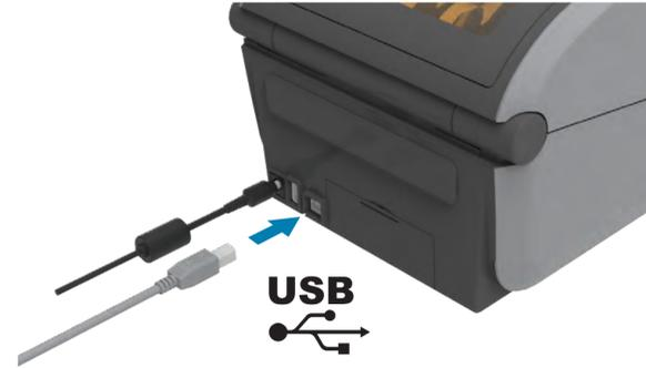
Conecte um cabo USB à impressora, conecte a outra extremidade ao seu computador.
