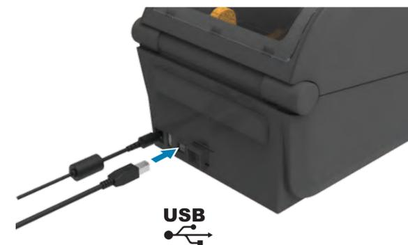
Conecte um cabo USB à impressora, conecte a outra extremidade ao seu computador.
