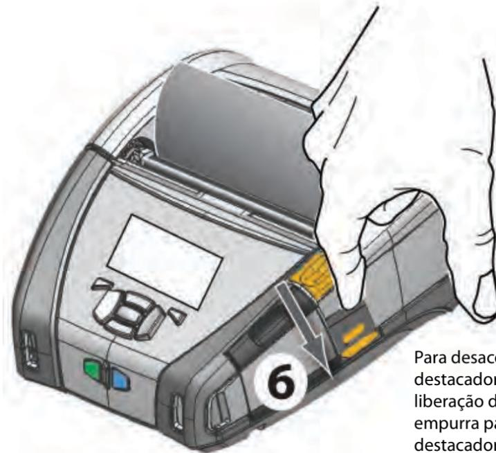
Para desacoplar o sujeitador do destacador, pressione o botão de liberação do destacador enquanto empurra para baixo a alavanca do destacador até que ela se encaixe na posição inicial.
