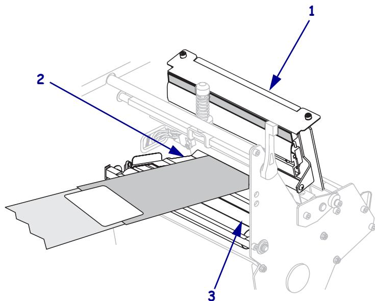
8. Passe a extremidade guia da fita sobre o rolo de fita superior (1) e na direção da haste de avanço da fita (2).
