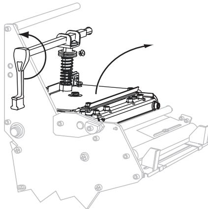
6. Passe a extremidade guia da fita e a fita sobre o rolo inferior (1) e sob o rolo superior (2).
