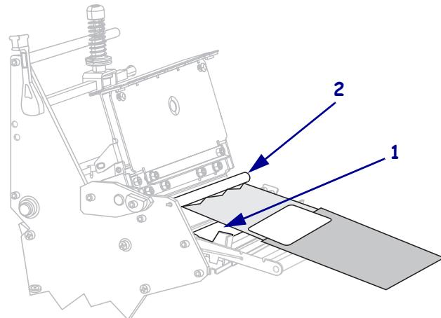
7. Empurre a extremidade guia de fita para frente até ela passar sob o jogo do cabeçote de impressão (1), sobre a placa de encaixe (2) e, em seguida, sobre o rolo de impressão (3).
