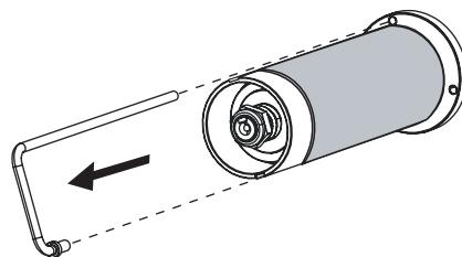
4. Deslize a fita usada para fora da haste de avanço e descarte-a.
