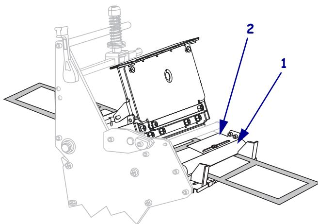
9. Empurre a mídia para frente até ela passar sob o jogo do cabeçote de impressão (1), sob a placa de encaixe (2) e, em seguida, sobre o rolo de impressão (3).
