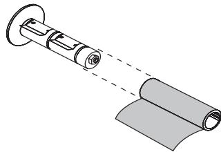
4. Uma extremidade guia facilita a carga e a remoção da fita. O rolo de fita tem papel ou alguma outra coisa presa na extremidade para servir como guia?
