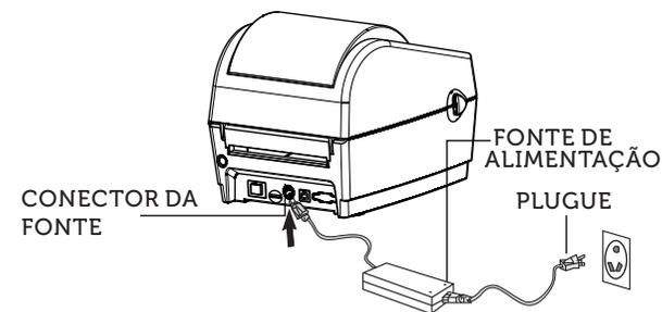
**ATENÇÃO:** A impressora deve estar "desligada" quando o cabo da fonte for conectado a ela.
