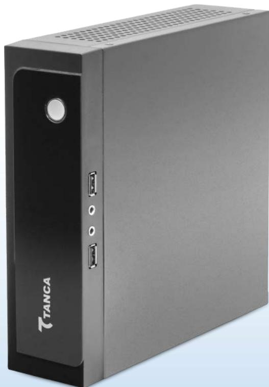
As CPUs **TC-6220** e **TC-6440** são as menores do mercado com até 4 seriais, 6 USBs e melhor custo x benefício da categoria de Mini PCs. Sua fonte externa possibilita a rápida substituição, além de suportar expansão Wi-fi.
